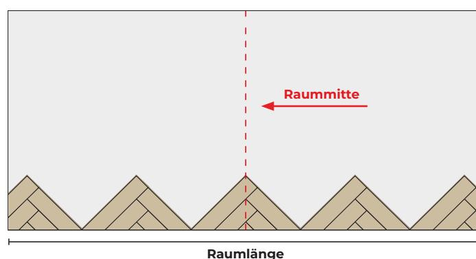
Messen Sie die Breite des Raums, in dem der Boden verlegt werden soll, und ermitteln Sie daraus, wie viele Dreiecke für den Aufbau der ersten Verlegereihe benötigt werden.
