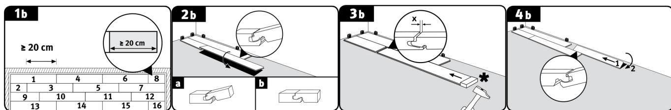
Dans cette position inclinée, rapprocher au maximum la latte 3 du bord avant de la latte 2 pour que la partie avant mâle de la latte 3 soit sur le fraisage de la partie femelle de la latte 2 (**fig. 3b**). Verrouillez ensuite le raccordement longitudinal en abaissant la planche 3. Assurez-vous brièvement que le mâle avant n'est pas trop haut par rapport au raccordement avant de la planche 2 (**fig. 3b**).
