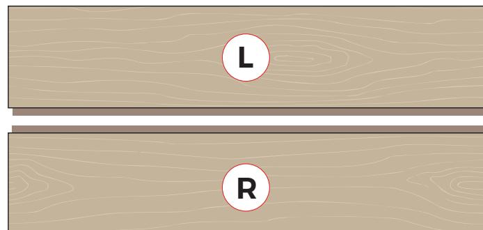
Um ein einheitliches Verlegemuster zu erzielen, sollte das Fischgrätenmuster immer ausgehend von der Raummitte verlegt werden. Messen Sie dazu die Raummitte aus und zeichnen Sie an dieser Stelle eine Referenzlinie auf dem Unterboden. Beginnen Sie dann mit der Installation, indem Sie eine erste Reihe von Dreiecken bilden – siehe Abbildung:
