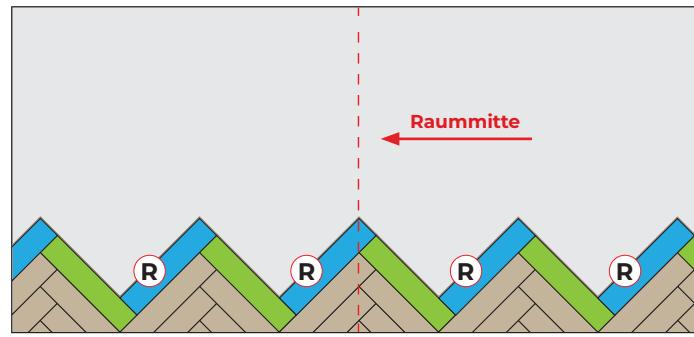
Verwenden Sie die aus den für die Startreihe vorbereiteten Dreiecke gewonnenen Schnitte, um die offenen Räume zu den Außenwänden hin zu schließen.
