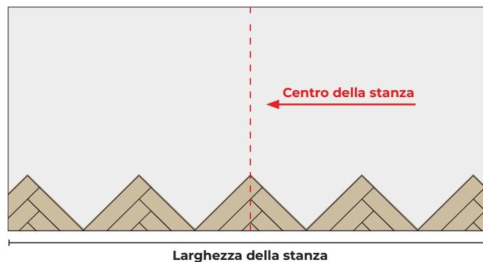
Misurare la larghezza della stanza dove il pavimento deve essere installato ed utilizzarla per capire quanti triangoli occorreranno per costruire la prima fila di installazione.
