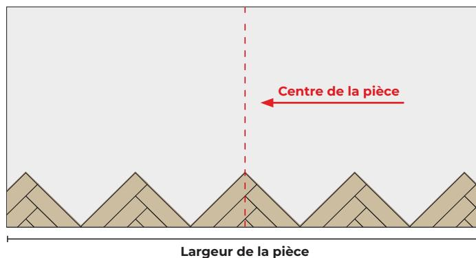
Mesurez la largeur de la pièce où le sol doit être installé et utilisez-la pour comprendre combien de triangles seront nécessaires pour construire la première rangée d'installation.
