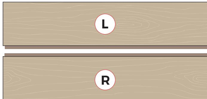
Le motif à chevrons doit toujours être installé en partant du centre de la pièce pour obtenir un motif d'installation uniforme. Pour ce faire, mesurez le centre de la pièce et tracez une ligne de référence sur le sous-plancher à cet endroit. Commencez ensuite la pose en formant une première rangée de triangles - voir illustration:
