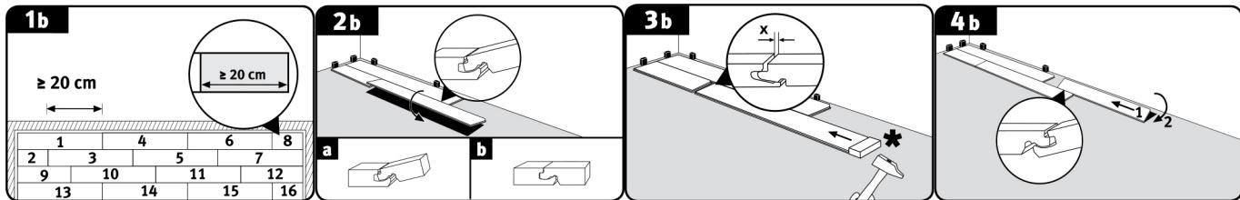
Bringen Sie in dieser abgewinkelten Position die Lamelle 3 so nah wie möglich an die Vorderkante der Lamelle 2, sodass der vordere männliche Teil der Lamelle 3 auf der Fräzung des weiblichen Teils der Lamelle 2 liegt (**Abb. 3b**). Verriegeln Sie anschließend die Längsverbindung durch Absenken der Diele 3. Achten Sie kurz darauf, dass die vordere Patrize nicht zu hoch im Vergleich zur vorderen Verbindung der Diele 2 steht (**Abb. 3b**).
