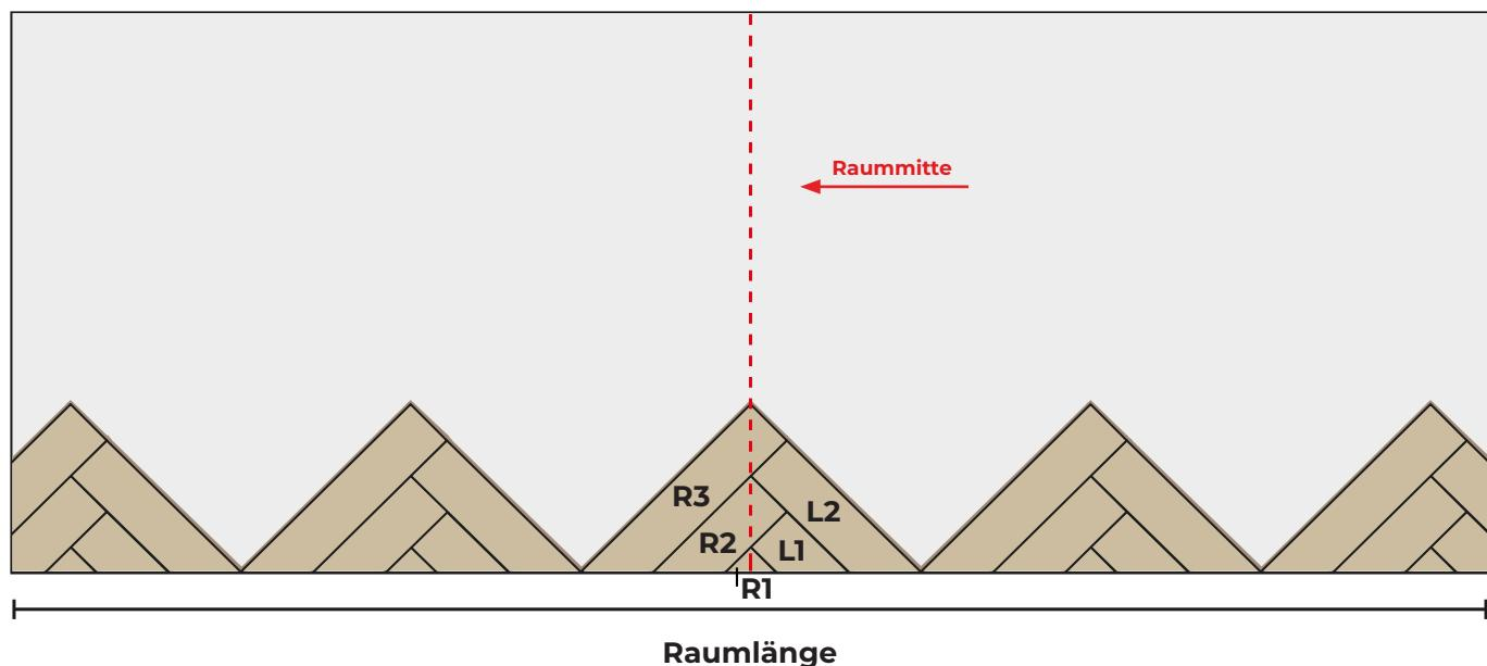
Nachdem alle Dreiecke der ersten Reihe angeordnet und ausgerichtet sind, verbinden Sie sie mithilfe von **L**-Lamellen miteinander.
