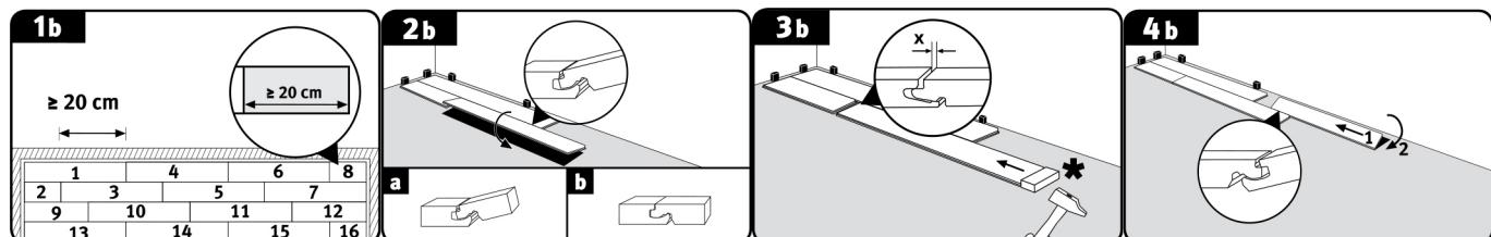
In questa posizione ad angolo, avvicinare il più possibile la doga 3 al bordo frontale della doga 2 in modo che il maschio frontale della doga 3 si trovi sulla fresatura della femmina della doga 2 (fig. 3b). Quindi bloccare il collegamento longitudinale abbassando la doga 3. Assicurarsi brevemente che il maschio frontale non sia troppo in alto rispetto al collegamento frontale della doga 2 (fig. 3b).
